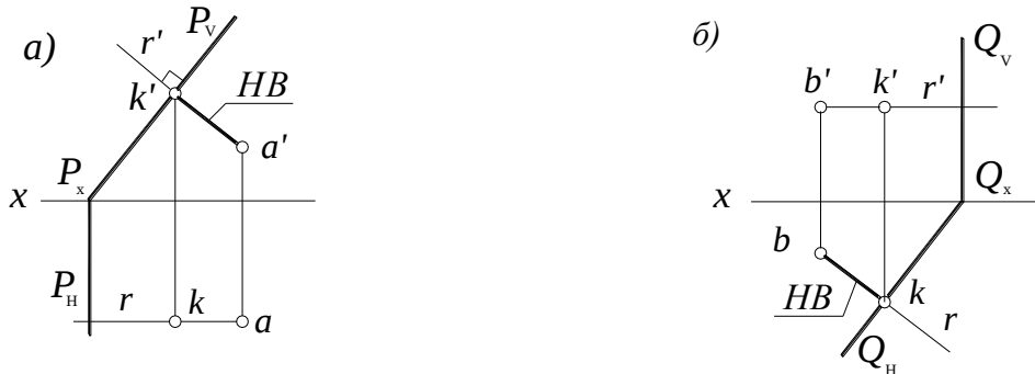
Рис. 1.40. Визначення відстані від точки до площини
